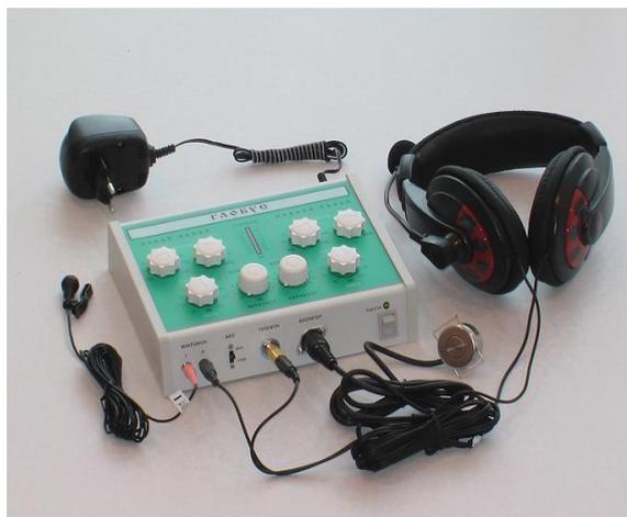
**Рис. 2.** Аппарат звукоусиливающий воздушной, костной проводимости и вибротактильного восприятия, детский АВКТ-Д-01 «Глобус»
