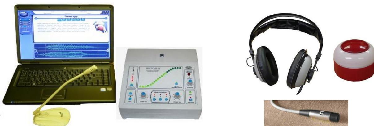
Рис. 5. Мультисенсорный речевой тренажер «ИНТОН-М» для работы с компьютерными программами
