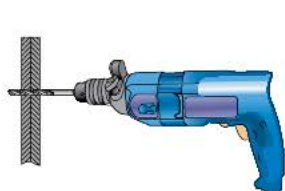
Рис. 5.50. Последовательность соединения заклёпками двух листов металла: а — сверление двух листов; б — процесс клёпки; в — склёпанная заготовка
