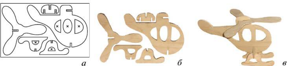
Рис. 3.8. Модель вертолѐта: а — шаблоны деталей на бумаге; б — заготовки деталей из фанеры; в — модель вертолѐта без декоративной отделки
