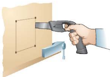
Рис. 4.45. Приём выпиливания внутреннего контура узкой выкружной ножовкой
