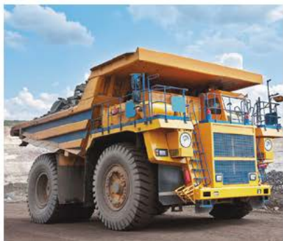
Рис. 3.1. Карьерный самосвал грузоподъёмностью 610 тонн
