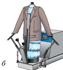
Рис. 6.25. Оборудование для влажно-тепловых работ: а — пресс; б — паровоздушный манекен
