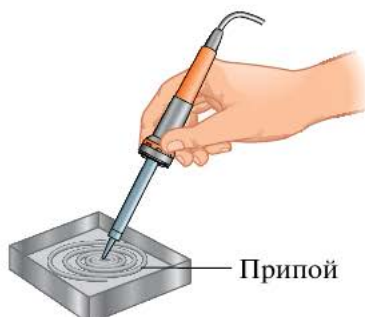
Рис. 5.61. Подготовка рабочей части (наконечника) паяльника
