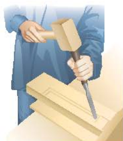
Рис. 4.55. Приём долбления на подкладной доске
