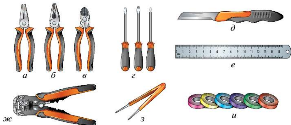
Рис. 10.1. Электромонтажные инструменты и изоляционные материалы: а — круглогубцы; б — плоскогубцы; в — бокорезы; г — отвертки; д — нож электрика; е — слесарная линейка; ж — приспособление для снятия изоляции; з — пинцет монтажный; и — изоляционные ленты
