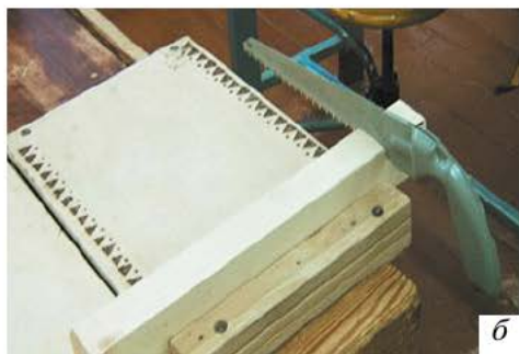
Рис. 1.6. Подкладная доска для столярного верстака: а — рабочий вариант; б — процесс пиления деревянного бруска на подкладной доске
