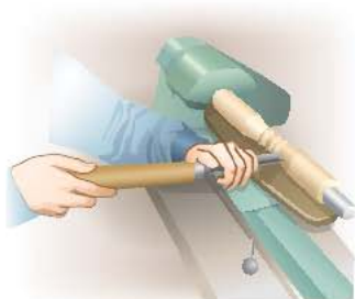
Рис. 4.32. Приёмы хвата полукруглой стамески
