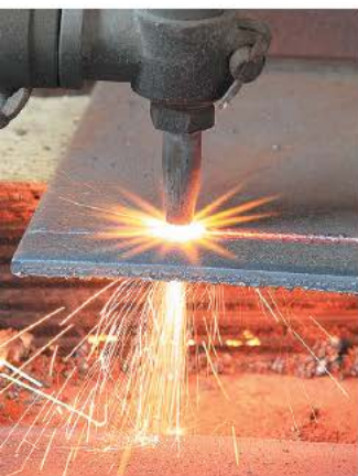
Рис. 2.1. Газовая резка металла
