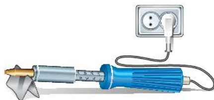
Рис. 5.59. Включение электрического паяльника в сеть
