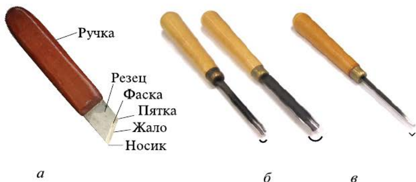
Рис. 8.3. Инструменты для контурной резьбы: а — нож-косяк; б — стамеска-уголок; в — полукруглые стамески
