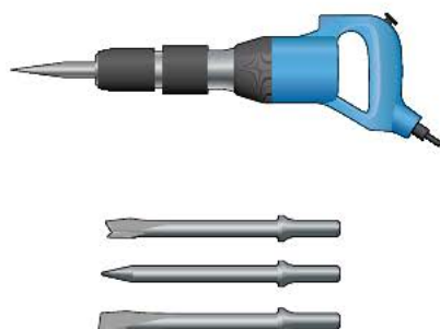
Рис. 5.17. Пневматический рубильный молоток с набором сменных зубил
