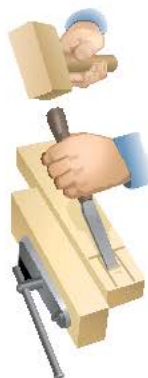
Рис. 4.56. Приём долбления в зажиме верстака
