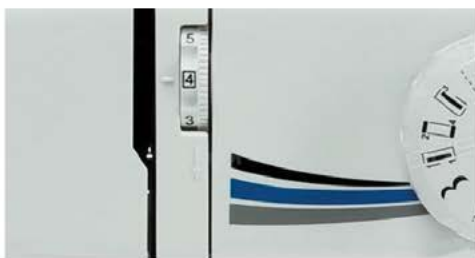
Рис. 6.15. Регуляторы натяжения верхней нити швейной машины
