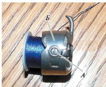
Рис. 6.17. Регулирование натяжения нити шпульного колпачка
