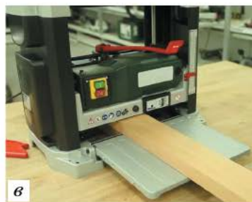
Рис. 3.27. Электрические инструменты и станки для строгания древесины: а — рубанок ручной; б — строгальный станок; в — рейсмусовый станок
