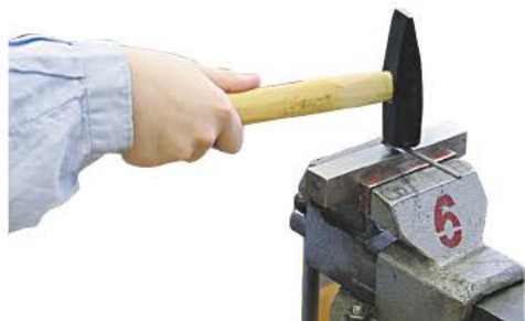
Рис. 4.14. Приёмы гибки проволоки в слесарных тисках с помощью стальной оправки
