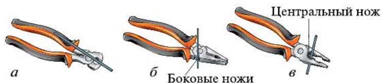
Рис. 4.17. Приёмы откусывания проволоки: а — кусачками; б — пассатижами боковыми ножами; в — пассатижами центральным ножом
