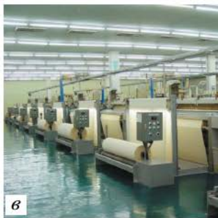
Рис. 5.7. Ткацкие станки: а — деревянный ручной; б — механический; в — автоматизированный
