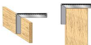
Рис. 3.33. Контроль строгания столярным угольником
