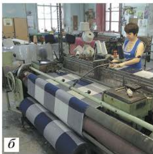
Рис. 5.7. Ткацкие станки: а — деревянный ручной; б — механический; в — автоматизированный
