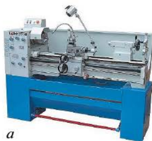
Рис. 10.8. Металлорежущие станки: а — токарный по металлу; б — сверлильный; в — фрезерный
