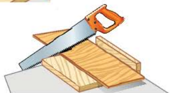
Рис. 3.24. Приёмы пиления столярной ножовкой: а — бруска поперёк волокон с применением подкладной доски; б — доски вдоль волокон с применением направляющего бруска; в — фанеры вдоль волокон; г — доски под углом к волокнам
