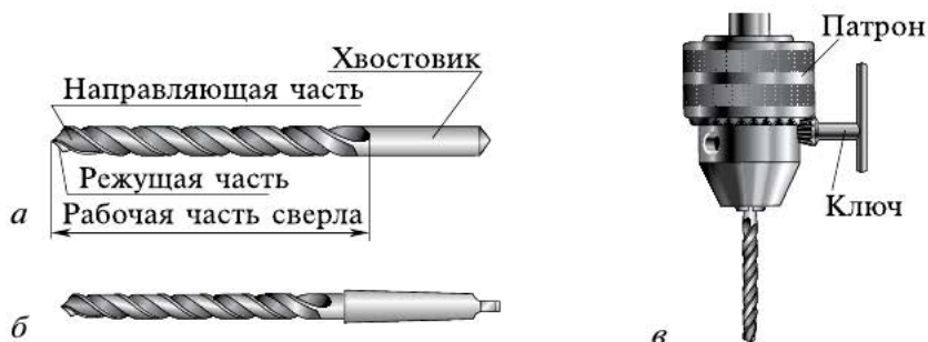
Рис. 4.35. Спиральное сверло: а — с цилиндрическим хвостовиком; б — с коническим хвостовиком; в — в патроне сверлильного станка
