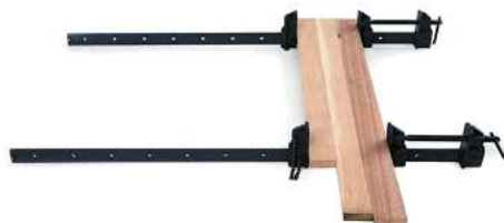
Рис. 3.44. Склеивание обрезных досок с использованием струбцин
