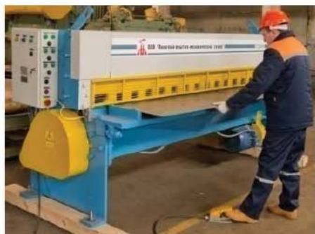
Рис. 4.27. Процесс резки металлического листа на гильотинных ножницах (станке)
