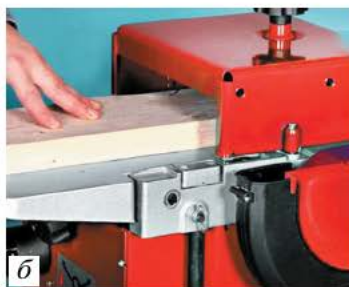
Рис. 3.27. Электрические инструменты и станки для строгания древесины: а — рубанок ручной; б — строгальный станок; в — рейсмусовый станок
