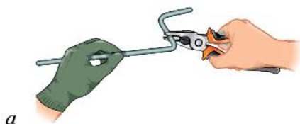
Рис. 4.15. Приёмы сгибания проволоки: а — плоскогубцами; б — круглогубцами
