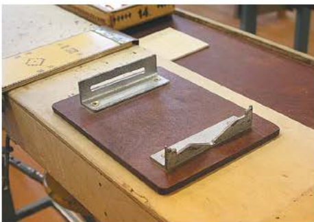
Рис. 7.21. Приспособление для закрепления пилки ручного лобзика
