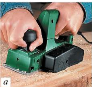
Рис. 3.27. Электрические инструменты и станки для строгания древесины: а — рубанок ручной; б — строгальный станок; в — рейсмусовый станок
