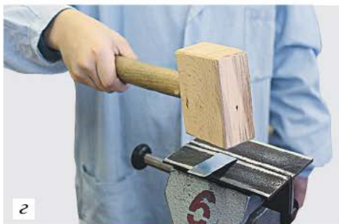
Рис. 4.29. Приспособления и приёмы гибки заготовки из тонколистового металла в слесарных тисках: a — оправки; б — накладные губки на слесарных тисках; в — приём гибки заготовки на угольной оправке; г — приём гибки заготовки на квадратной оправке
