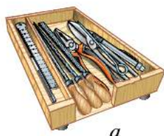
Рис. 4.3. Съёмное оборудование и инструменты: а — слесарная готовальня; б — съёмный экран для рубки металла; в — разметочная плита
