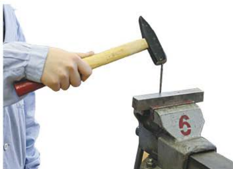
Рис. 4.14. Приёмы гибки проволоки в слесарных тисках с помощью стальной оправки
