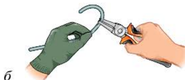
Рис. 4.15. Приёмы сгибания проволоки: а — плоскогубцами; б — круглогубцами
