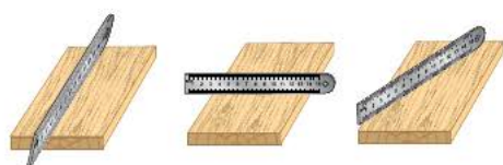
Рис. 3.32. Контроль строгания слесарной линейкой
