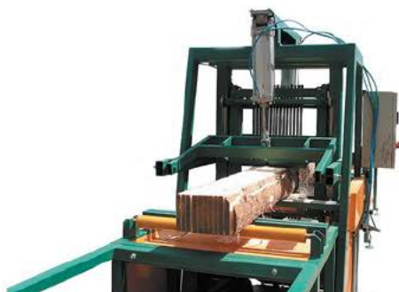
Рис. 3.8. Процесс распиловки бревна на лесопильном станке (пилораме)
