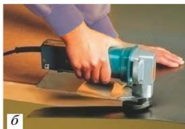
Рис. 4.25. Электрифицированные ножницы: а — внешний вид; б — использование при резании металла
