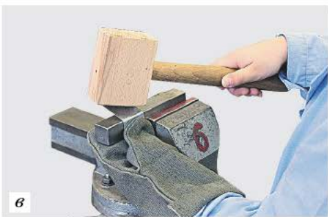
Рис. 4.29. Приспособления и приёмы гибки заготовки из тонколистового металла в слесарных тисках: a — оправки; б — накладные губки на слесарных тисках; в — приём гибки заготовки на угольной оправке; г — приём гибки заготовки на квадратной оправке
