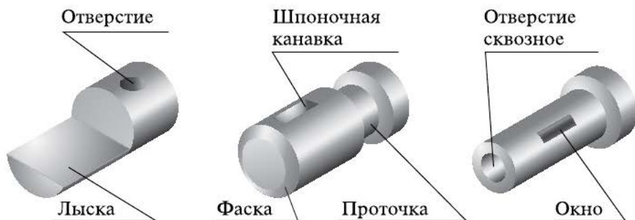
Рис. 2.8. Примеры конструктивных элементов деталей
