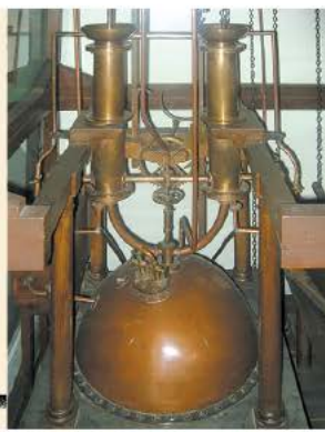
Рис. 9.11. Чертёж и модель машины И. И. Ползунова
