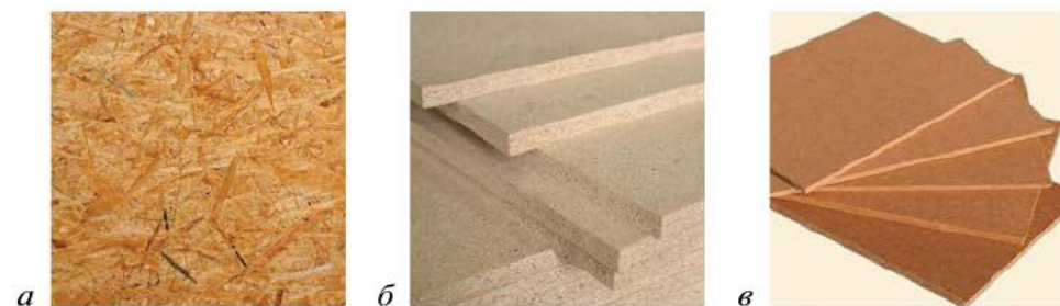
Рис. 3.14. Древесные материалы: а — древесно-волоконистые плиты; б — древесно-стружечные плиты; в — древесно-слоистый пластик
