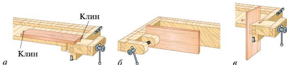
Рис. 3.3. Закрепление заготовки: а — для строгания на плоскости; б — в переднем зажиме; в — в заднем зажиме
