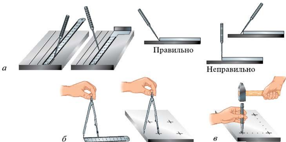
Рис. 4.7. Приёмы разметки: а — прямых линий; б — перенос размеров циркулем; в — накернивание молотком разметочных точек
