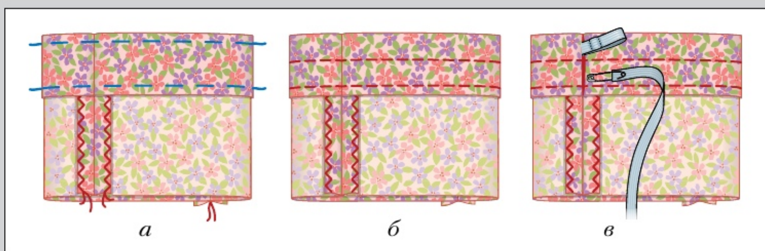
Рис. 105. Обработка пояса-кулиски юбки: а — запётыывание; б — застрачивание; в — продевание резиновой тесьмы
