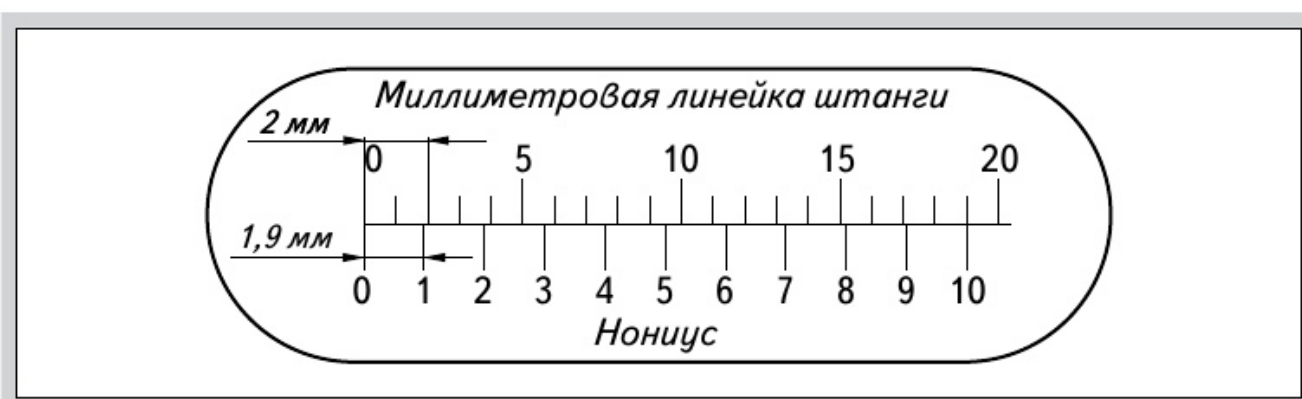
Рис. 36. Шкала штанги и нониус
