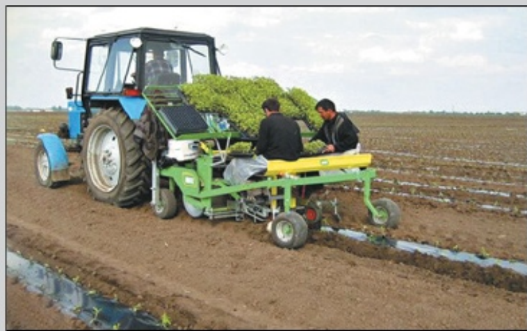
Рис. 136. Сельскохозяйственная техника для посадки: а — сеялка; б — рассадопосадочная машина
