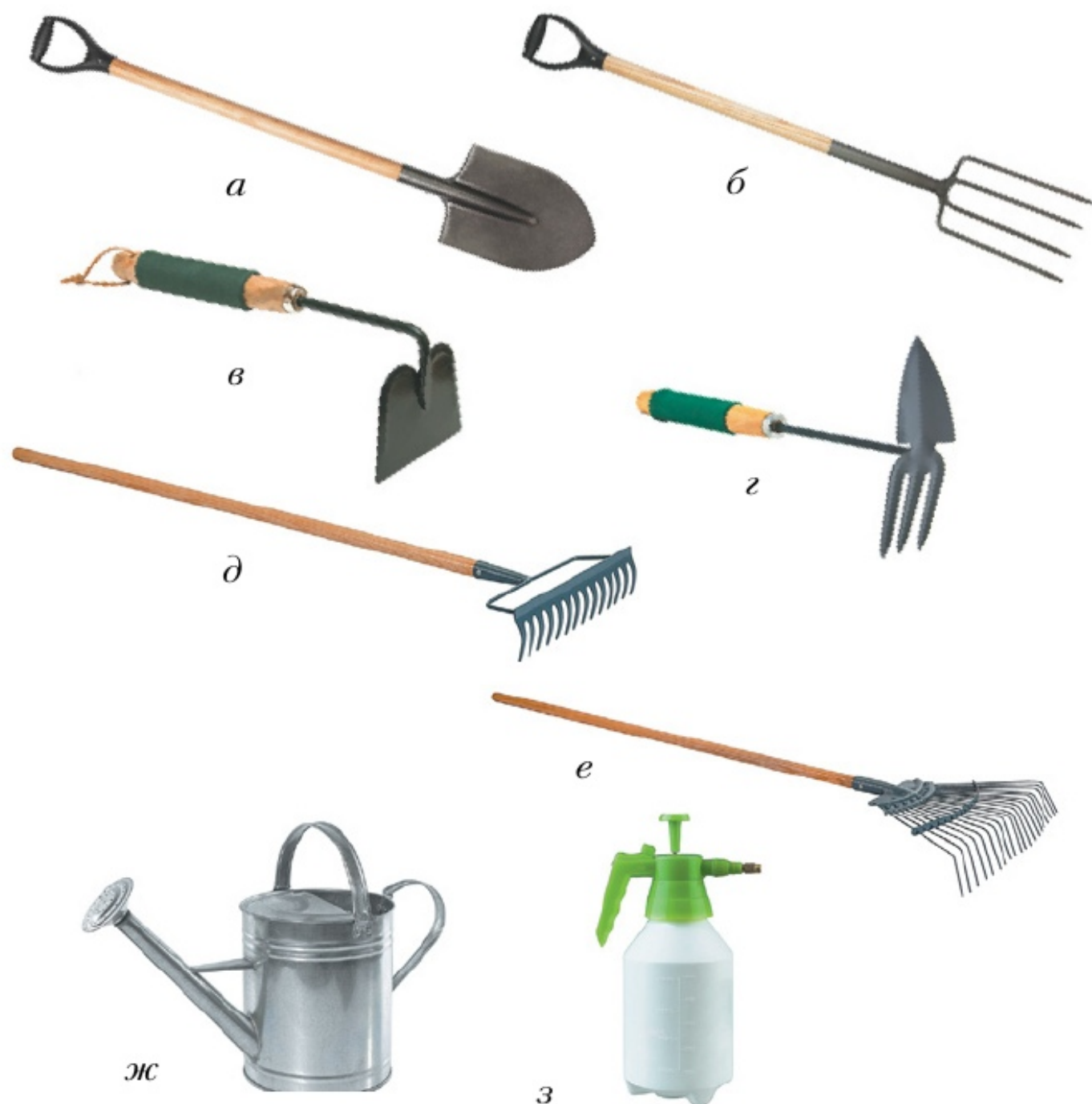
Рис. 137. Садовый инструмент: а — лопата; б — вилы; в — мотыга; г — мотыжка комбинированная; д — грабли; е — грабли веерные; ж — лейка; з — опрыскиватель
