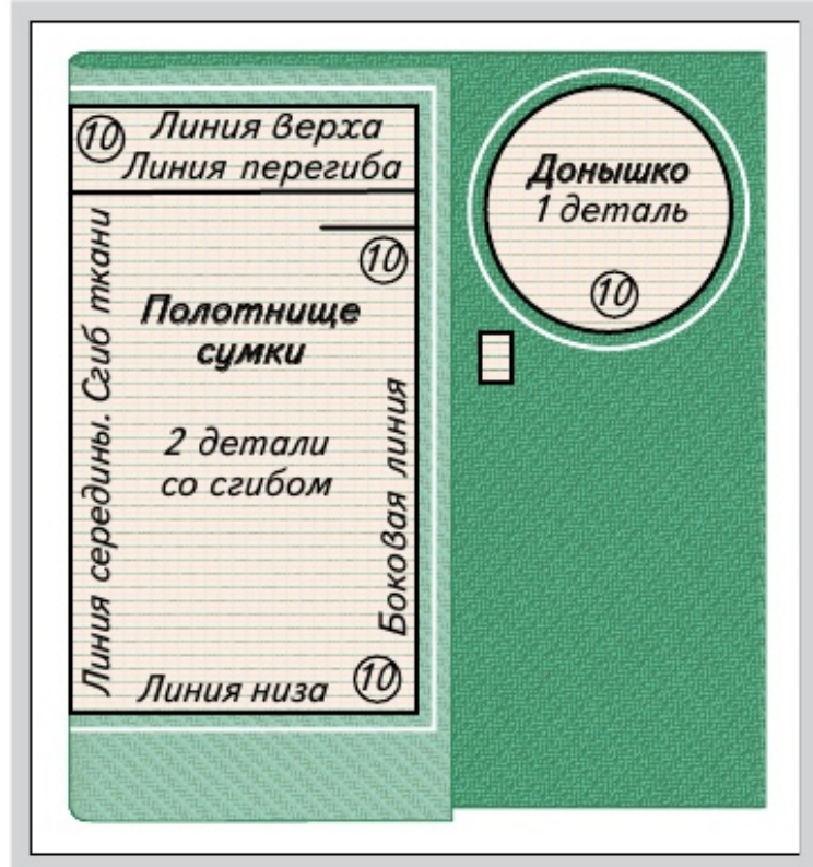
Рис. 106. Раскладка выкроек сумки-торбы на ткани
