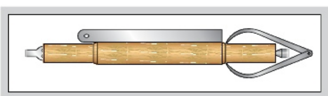
Рис. 61. Контроль качества детали с помощью линейки и кронциркуля
