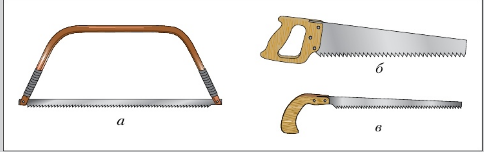
Рис. 48. Инструменты для пиления заготовок из древесины: а — лучковая пила; б — столярная ножовка; в — выкружная пила
