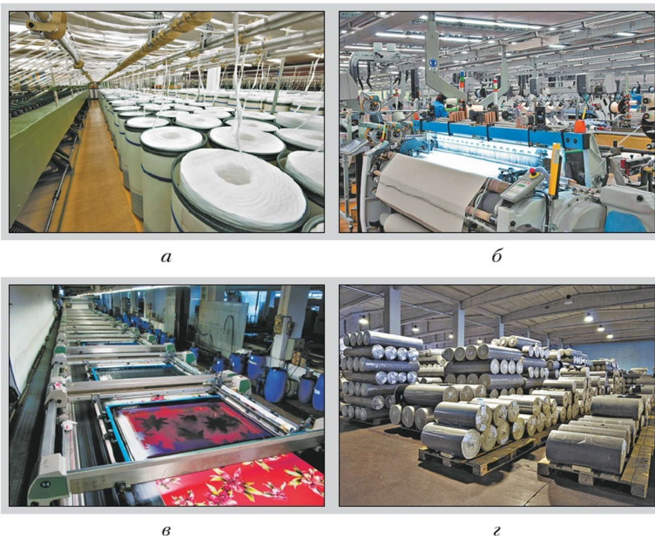
Рис. 118. Современное ткацкое производство: а — прядильный цех; б — ткацкий цех; в — красильно-отделочный цех; г — склад готовой продукции
