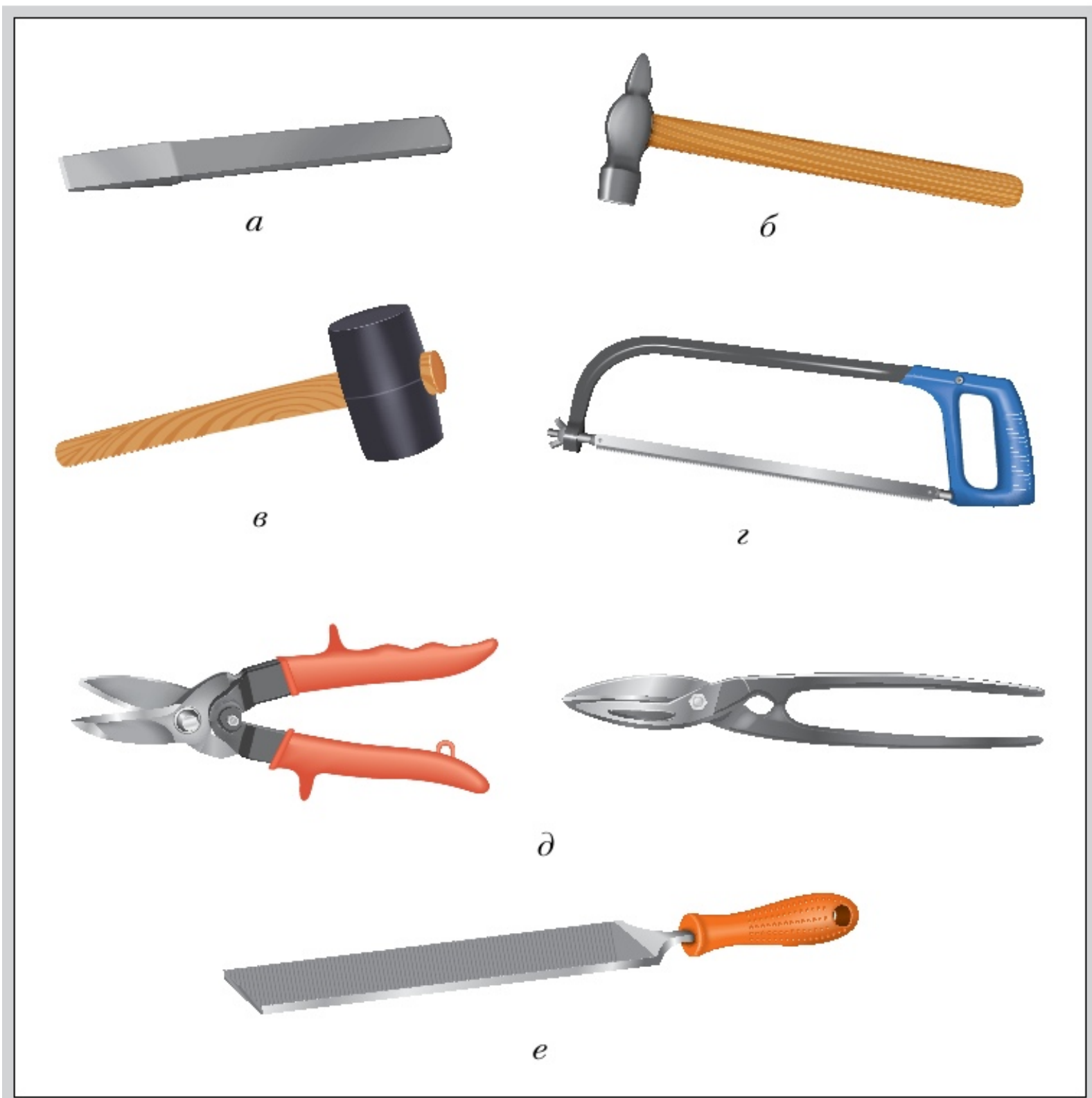
Рис. 27. Инструменты для ручной обработки тонколистового металла и проволоки: а — зубило; б — слесарный молоток; в — киянка; г — ножовка; д — ножницы по металлу; е — напильник
