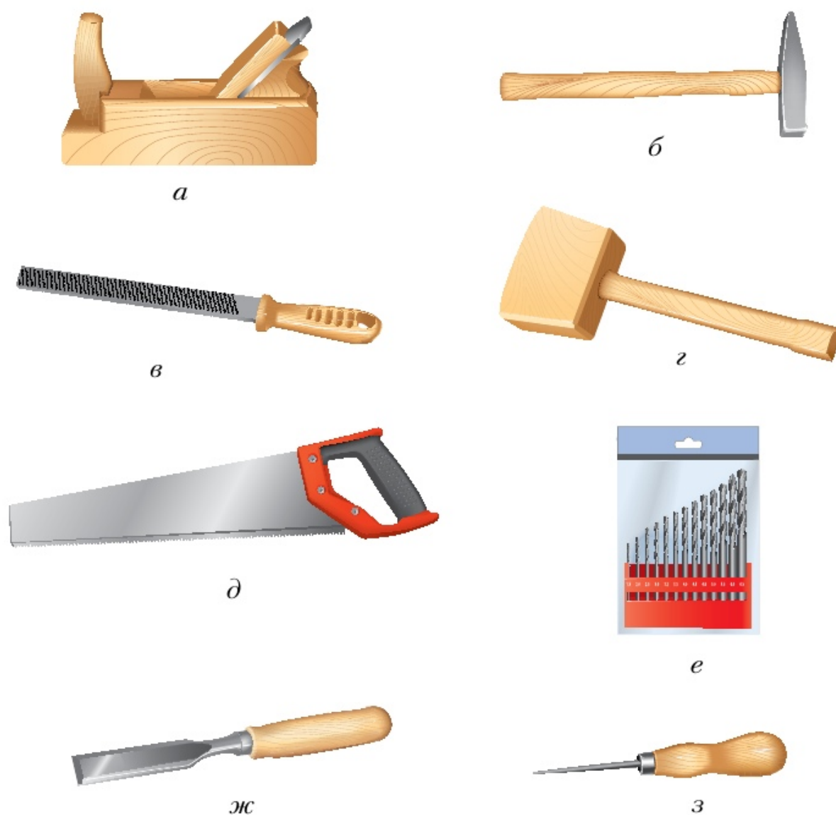
Рис. 24. Основные инструменты для обработки древесины: а – рубанок; б – молоток; в – напильник; г – киянка; д – ножовка; е – свёрла; ж – стамеска; з – шило
