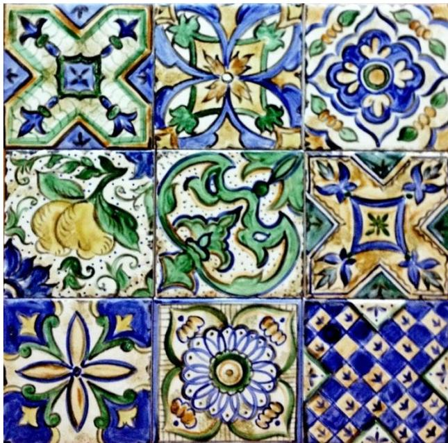
Фаянсовая плитка (глазурованная) изготавливается путем прессования сырьевой смеси, в результате получается плотная белая основа. На нее наносится прозрачная или непрозрачная глазурь. Фаянсовая плитка подвергается двойному обжигу, она отличается высокой прочностью и может применяться как для облицовки стен, так и для отделки пола.
