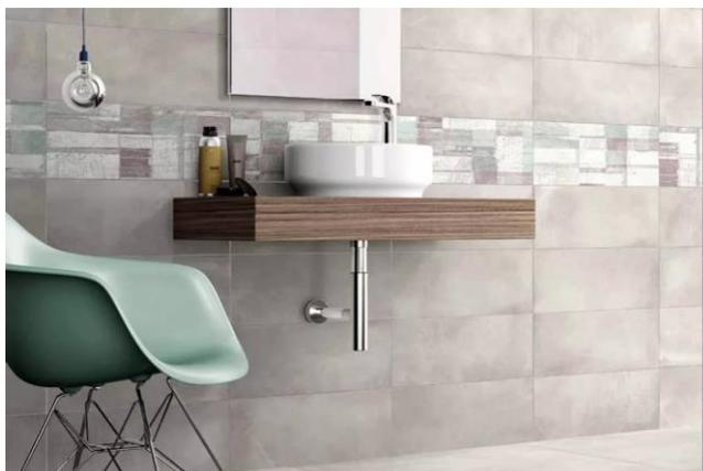
Монопороза – керамическая плитка одинарного обжига, производится путем прессования с последующим обжигом после нанесения глазури.
