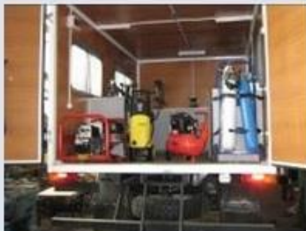
Передвижной ремонтно-диагностический пост (мастерская) для тракторов и самоходных машин на базе автомобиля ГАЗ-3309
