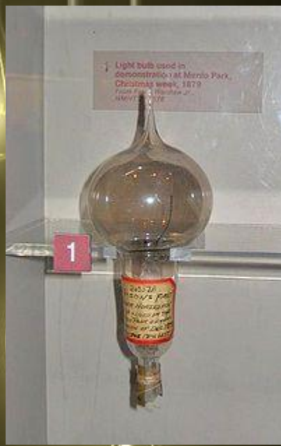
Лампа Эдисона с угольной нитью
