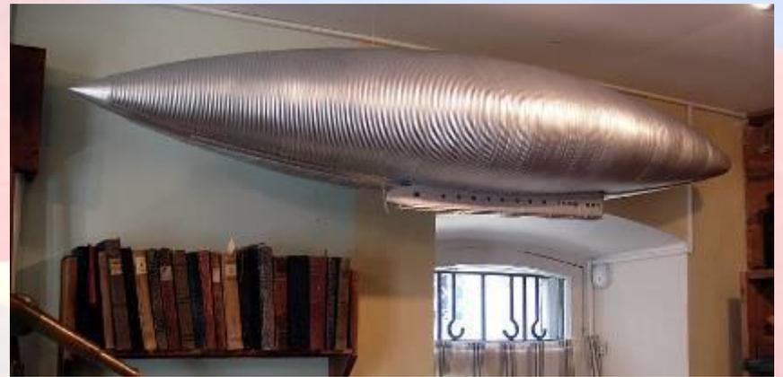
Модель оболочки аэростата из гофрированного металла
