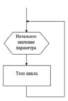
Puc. 106. Блок-схема цикла
