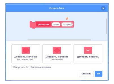
**Puc. 152.** Вид диалогового окна для создания подпрограммы с несколькими параметрами Новый блок также отображается в соответствующем разделе (рис. 153).
