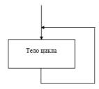
Puc. 108. Блок-схема цикла
