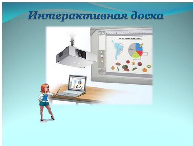
Интерактивная доска - это сенсорный экран, работающий как часть системы, в которую также входят компьютер и проектор. Компьютер передает сигнал на проектор. Проектор
