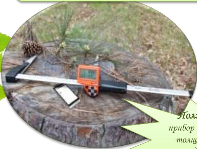
*Полнотомер – прибор для измерения толщины стволов деревьев.*
