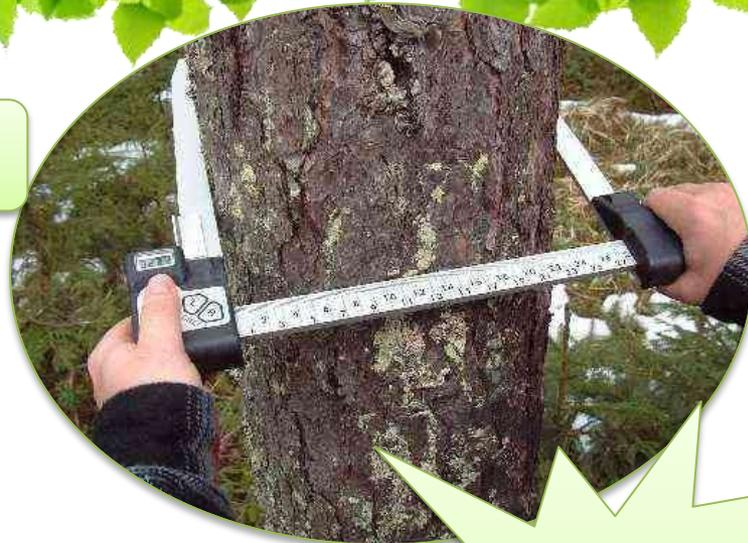
*Мерная вилка – используется для измерения диаметра ствола.*
