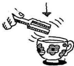
Многие увлажнители воздуха в жилых помещениях основаны на таком же принципе. Вода из специального резервуара попадает в испарительную камеру. Нижняя часть камеры колеблется с очень высокой частотой, которую человеческое ухо не может зафиксировать (поэтому такая частота называется ультразвуковой). Энергия колебаний передается воде, и частицы воды получают достаточно энергии, чтобы вылететь из камеры в окружающий воздух.
