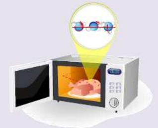
Рис. 4. Переменное поле в микроволновой печи раскачивает молекулы
