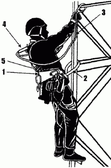
Система позиционирования, позволяющая работнику работать с поддержкой, при которой падение предотвращается.
