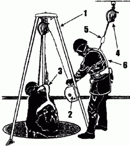
Система спасения и эвакуации, использующая переносное временное анкерное устройство и встроенное спасательное подъемное устройство;
