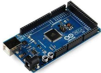
Рис.1 Плата Arduino Mega
