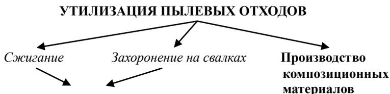
Рис. 1. Способы утилизации пылевидных отходов хлопкопрядильных производств
